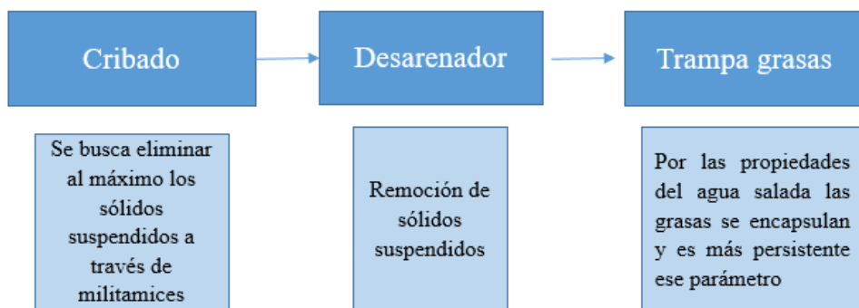
Figura 2. Secuencia de operaciones unitarias requeridas para una PTAR que dispone en medio marítimo
