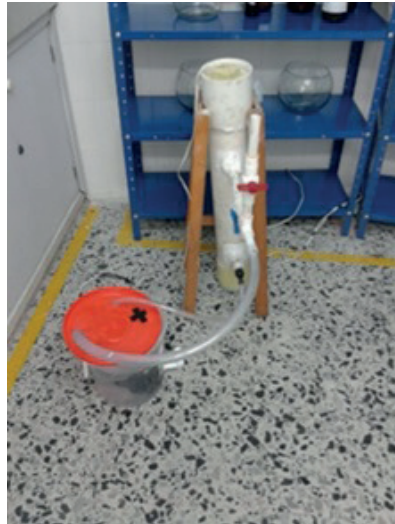
Figura 2. Reactor de oxidación química
