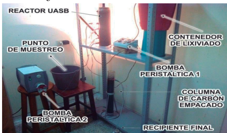
Figura 1. Sistema combinado UASB- adsorción
