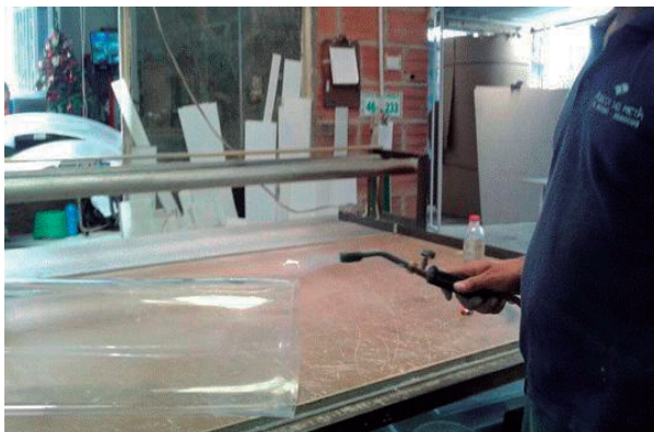
Figura 2. Calentamiento de la lámina de acrílico
