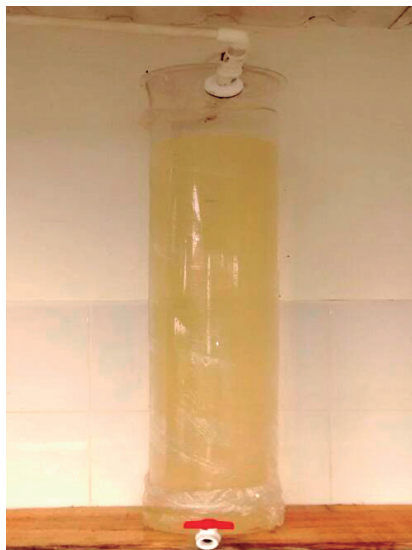
Figura 8. Llenado del filtro para verificar si hay fugas de agua
