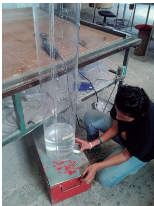
Figura 4. Prueba de sellamiento del tubo
